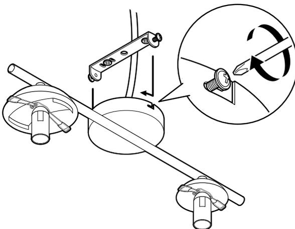
2. Schieben Sie den Baldachin nach oben über die Befestigungsschrauben und drehen Sie die Befestigungsschrauben wieder fest.
