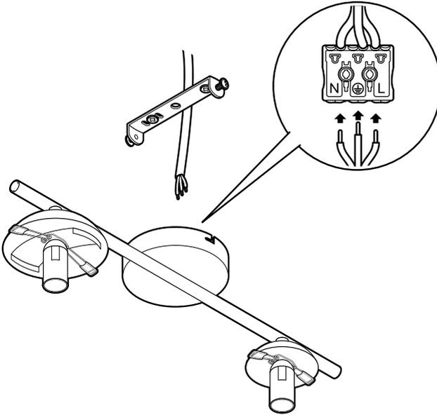
1. Lassen Sie die Stromleitung von einer Fachkraft mit der Lüsterklemme verbinden.
