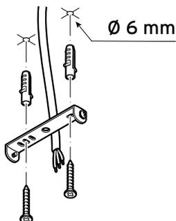
1. Markieren Sie mit Hilfe des Deckenbügels die Bohrlöcher an der Decke.
