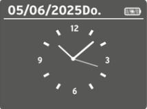
Im Standby werden im Display Datum und Uhrzeit angezeigt.
