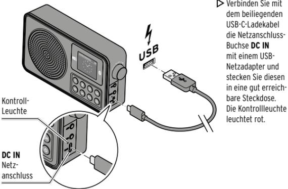
Ein normaler Ladevorgang dauert bei leerem Akku ca. 3,5 Stunden (bei 5 V / 1 A Eingangsrate). Sobald der Akku vollständig geladen ist, erlischt die Kontroll-Leuchte.
