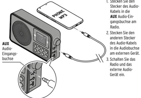
1. Stecken Sie den Stecker des Audio-Kabels in die **AUX** Audio-Eingangsbuchse am Radio.
