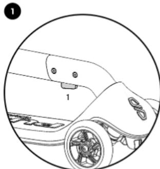
Per il montaggio bisogna smontare ed erigere il manubrio. Il pulsante (1) sulla parte inferiore del manubrio serve allo smontaggio e al montaggio.
