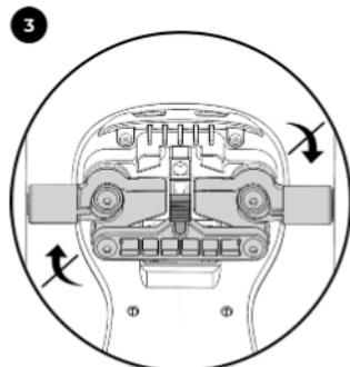
Le poussoir est maintenant bloqué en position arrière et bloque le mouvement de direction.
