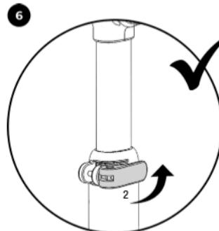
После настройки нужной высоты руля зафиксируйте его, закрыв быстродействующий зажим (2).
