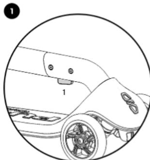
Для монтажа необходимо демонтировать и выровнять рулевую стойку. Кнопка (1) на нижней стороне рулевой стойки используется для демонтажа / монтажа.
