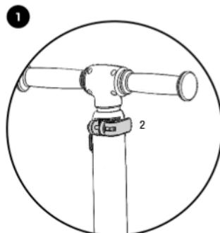
Wysokość kierownicy jest zabezpieczona przez zacisk (2) z tyłu.
