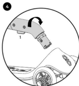
Поверните рулевую стойку на 180° и выровняйте её параллельно платформе, чтобы кнопка (1) была направлена вниз.
