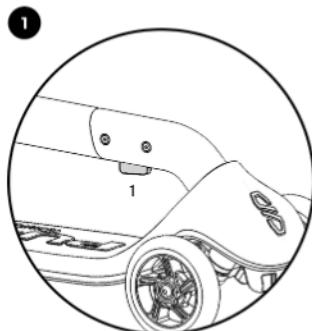
Para el ensamblaje ha de desmontarse el manillar y enderezarse. El botón (1) de la parte inferior del manillar sirve para el montaje y el desmontaje.
