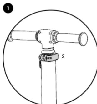
Высота руля фиксируется быстродействующим зажимом (2) на задней стороне рулевой стойки.
