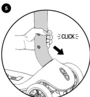
Przytrzymać wcisnięty przycisk (1), wkładając ponownie kierownicę w podest. Wcisnąć kierownicę w podest w taki sposób, aby się zatrzasnęła.
