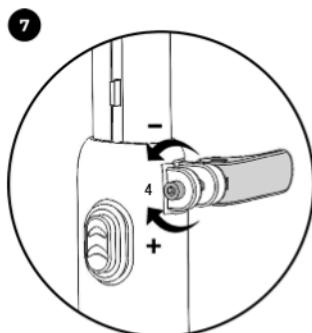
Klemmekraften på lynkoblingen kan indstilles på skruen (4) ved hjælp af en 5 mm unbrakongle. Drej denne med urets retning for at øge klemmekraften, eller mod urets retning for at reducere den.
