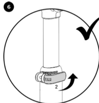
Po ustawieniu żądanej wysokości kierownicy należy ją zabezpieczyć przez zamknięcie zacisku (2).
