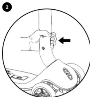
Возмитесь за рулевую стойку так, чтобы полностью вдавить кнопку (1) спереди на рулевой стойке.
