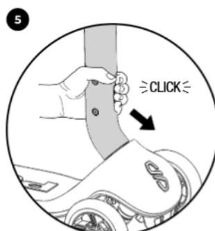
Держите кнопку (1) нажатой, когда вы вставляете рулевую стойку в платформу. Вставьте рулевую стойку в платформу так, чтобы она зафиксировалась со щелчком.
