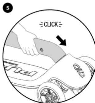
Przytrzymać wcisnięty przycisk (1), wkładając ponownie kierownicę w podest. Wcisnąć kierownicę w podest w taki sposób, aby się zatrzasnęła.
