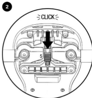
Skjut reglaget (5) bakåt för att aktivera raktframköring, tills att det hakar fast med ett distinkt ljud.
