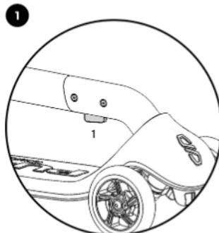
För monteringen måste styrstången demonteras och riktas in. Knappen (1) på styrstångens undersida används för de-/montering.
