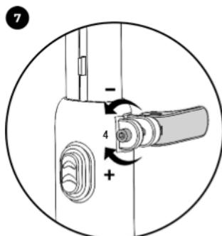
Snabbspännarens fastspänningsskraft kan ställas in med skruven (4) med hjälp av en 5 mm insèxnyckel. Vrid den medurs för att öka fastspänningsskraften, eller motsols för att minska den.
