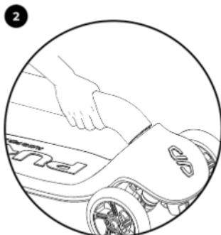
Uchopte tyč řidítka tak, že úplně zatlačíte tlačítko (1) na spodní straně tyče řidítka.
