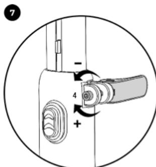
Pikakiinnittimen kiinnitysvoima voidaan säätää ruuvilla (4) 5 mm:n kuuksikoloavaimella. Käännä tätä myötäpäivään nostaaksesi kiinnitysvoimaa tai vastapäivään vähentääksesi kiinnitysvoimaa.
