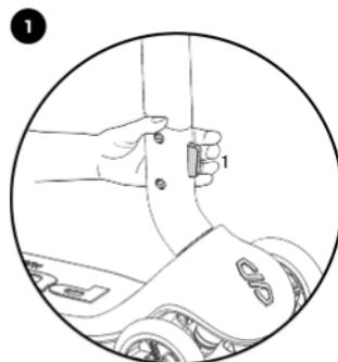
For lettere at kunne transportere eller opbevare PUKY PUSH, kan den komprimeres. Til dette formål skal man først afmontere styret. Betjeningselementet (1) til af-/påmontering sidder foran på styret.
