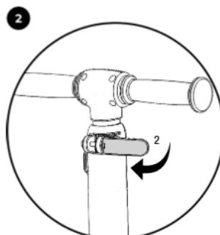
For at indstille styrets højde, skal du løsne grebet på lynkoblingen (2) på den højre side af styret.
