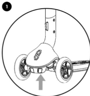
Lo sterzo del monopattino può essere bloccato mediante attivazione della guida rettilinea. Questo aiuta i bambini più piccoli e meno esperti ad abituarci. L'interruttore per la guida in rettilinea si trova sulla parte inferiore del monopattino.
