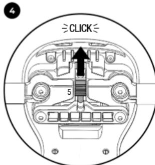
För att deaktivera raktframköring: skjut reglaget (5) framåt tills att det hakar fast med ett distinkt ljud.
