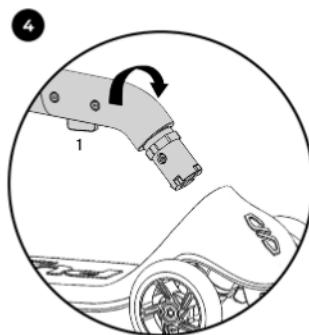
Obrócić kierownicę o 180° i wyównać ją równolegle do podestu tak, aby przycisk (1) był skierowany do dołu.
