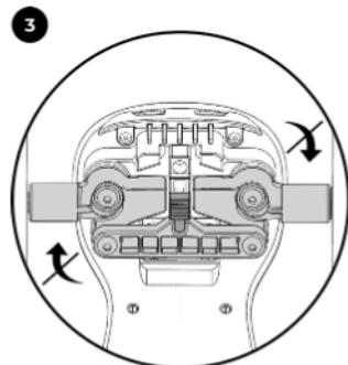
El deslizador se encuentra entonces enclavado en la posición posterior y bloquea el movimiento del manillar.
