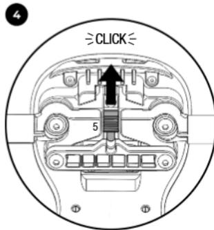
Para desactivar el dispositivo de estabilidad direccional, desplace el interruptor (5) hacia delante, hasta que engatille audiblemente.
