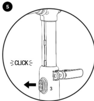
Vælg et af de fire niveauer for styrets højde. Styret klikker hørbart ind i niveauerne og knappen (3) springer tilbage til sin udgangsposition.
