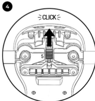
Для отключения функции прямого хода сдвиньте переключатель (5) вперёд до его фиксации со щёлчком.
