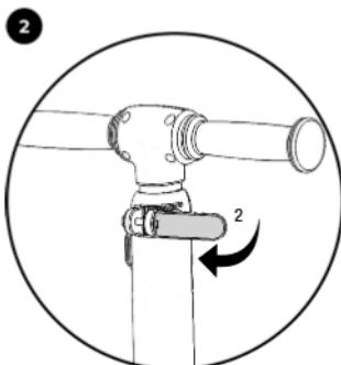
Aby przestawić wysokość kierownicy, należy poluzować dźwignię zacisku (2) z prawej strony kierownicy.
