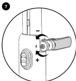
Upínací sílu rychloupínáče lze nastavit šroubem (4) pomocí imbusového klíče 5 mm. Otáčením ve směru hodinových ručiček zvýšete upínací sílu, otáčením proti směru hodinových ručiček ji snížete.
