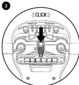
Pour activer le roulage en ligne droite, poussez l'actionneur (5) vers l'arrière jusqu'à ce qu'il s'enclenche de manière audible.
