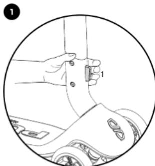
Pour faciliter le transport ou le stockage de la PUKY PUSH, elle peut être compactée. Pour cela, il faut d'abord démonter le guidon. L'élément de commande (1) pour le démontage / montage se trouve à l'avant du guidon.
