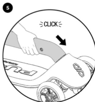
Держите кнопку (1) нажатой, когда вы вставляете рулевую стойку в платформу. Вставьте рулевую стойку в платформу так, чтобы она зафиксировалась со щёлчком.
