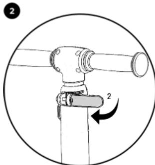
Para ajustar la altura del manillar suelte la palanca del dispositivo de bloqueo rápido (2) del lado derecho del manillar.
