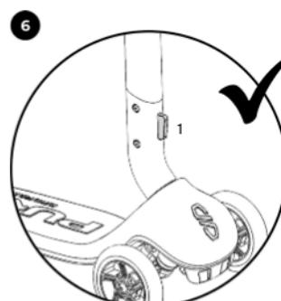
После этого кнопка (1) на передней части рулевой стойки должна снова полностью выйти. Теперь рулевая стойка зафиксирована в вертикальном положении.
