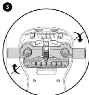
После этого ползунок оказывается зафиксирован в заднем положении, блокируя поворотные движения.
