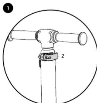
Ohjaus korkeussäätö on varmistettu pikakiinnittimellä (2) ohjaustangoon takasivulta.
