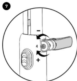
Зажимное усилие зажима быстродействующего зажима можно регулировать винтом (4) с помощью имбусового ключа на 5 мм. Поверните его по часовой стрелке, чтобы увеличить зажимное усилие, или против часовой стрелки, чтобы уменьшить.
