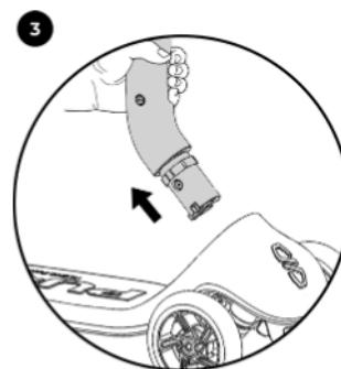
Wyciągnąć kierownicę do tyłu do góry z podestu.
