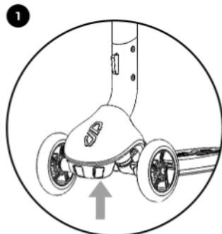
El manillar del scooter puede bloquearse conectando el dispositivo de estabilidad direccional. Esto sirve para que se vayan acostumbrando los niños de menos edad y experiencia. El interruptor del dispositivo de estabilidad direccional se encuentra en la parte inferior del scooter.
