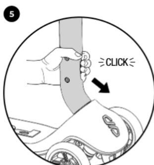
Mantenga el botón (1) presionado mientras inserta el manillar de nuevo en su anclaje. Presione el manillar en su anclaje hasta que engatille.
