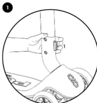
Pro snadnější přepravu a skladování lze koloběžku PUKY PUSH složit. Za tím účelem je třeba nejdříve odmontovat tyč říditek. Ovládací prvek (1) pro montáž/demontáž se nachází vpředu na tyči říditek.
