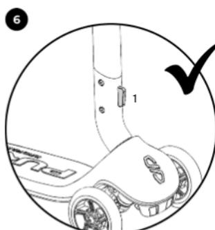
Przycisk (1) z przodu na kierownicy powinien ponownie całkowicie się wysunąć. Kierownica jest teraz zablokowana w pozycji wyrownanej.
