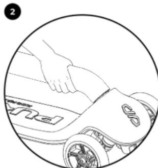
Возмитесь за рулевую стойку так, чтобы полностью вдавить кнопку (1) на нижней стороне рулевой стойки.
