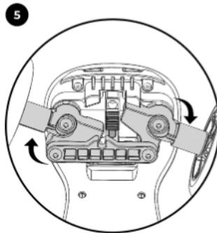
El interruptor se encuentra entonces bloqueado en la posición delantera y el movimiento del manillar queda liberado de nuevo.
