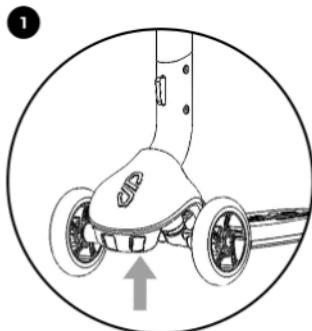
Scooterns styrning kan blockeras genom att man aktiverar rakt fram. Det hjälper yngre och mindre erfarna barn vid invändningen. Reglaget för raktframkörläge sitter på scooterns undersida.
