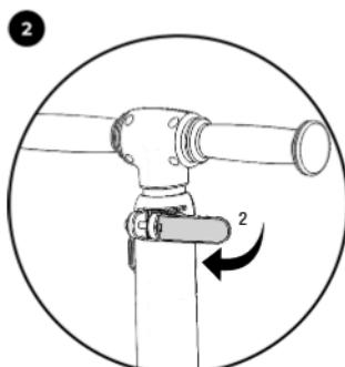
Ohjauskorkeutta voidaan säätää irrottamalla pikakiinnittimen (2) viipu ohjaustangoon oikealta puolelta.
