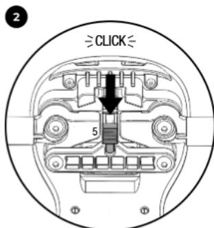
Для включения функции прямого хода сдвиньте переключатель (5) назад до его фиксации со слышимым щелчком.
