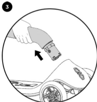
Wyciągnąć kierownicę do tyłu do góry z podestu.
