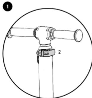
La altura del manillar se asegura por medio de un dispositivo de bloqueo rápido (2) del lado posterior del manillar mismo.
