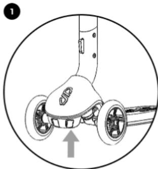
Styringen af scooteren kan blokeres med tilkobling af kørsel ligeud. Dette hjælper yngre og mindre erfarende børn med tilværenningen. Kontakten til kørsel ligeud sidder på undersiden af scooteren.
