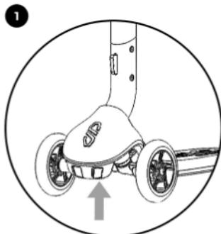
La direction de la trottinette peut être bloquée par l'enclenchement du roulage en ligne droite. Cela aide les enfants plus jeunes et moins expérimentés à s'adapter. L'actionneur pour le roulage en ligne droite se trouve sur le dessous de la trottinette.
