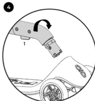
Tyč říditek otočte o 180° nastavte a vyrovnajte ji rovnoběžně s nášlapnou plochou tak, aby tlačítko (1) směrovalo dolů.
