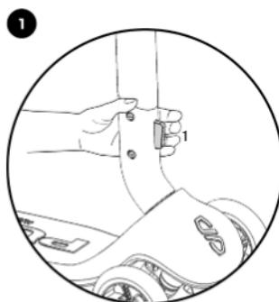
Aby łatwiej transportować lub przechowywać PUKY PUSH, można ją złożyć. W tym celu należy najpierw zdemontować kierownicę. Element obsługi (1) do demontażu/montażu znajduje się z przodu na kierownicy.
