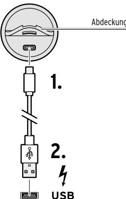
1. Öffnen Sie die Abdeckung unten am Handteil und stecken Sie den USB-C-Stecker des Ladekabels in die Anschlussbuchse.
