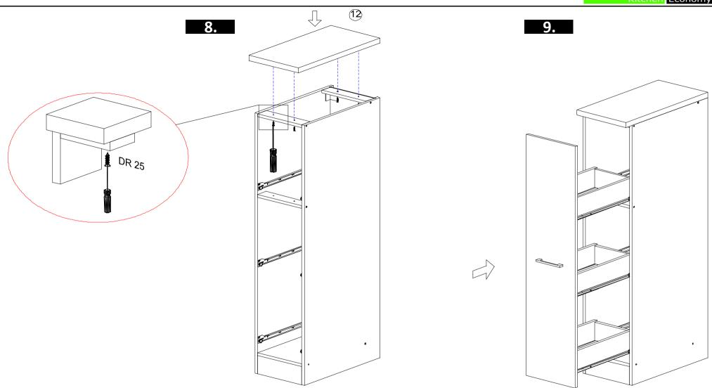
Falls beim Ausziehen die Tür nicht leicht genug funktioniert bitte die Schrauben DR25 lösen. Beginnen Sie mit der mitlleren Schublade. So kommt die Schublade auf die richtige Position und so können Sie auch die Schrauben DR25 richtig einschrauben.
