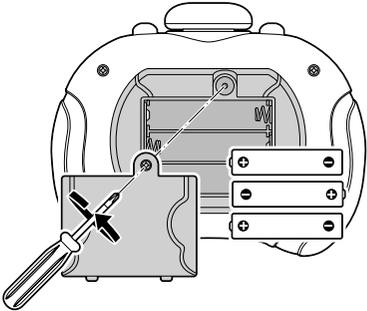
1. Lösen Sie die Schraube am Batteriefach und nehmen Sie den Batteriefachdeckel ab.
