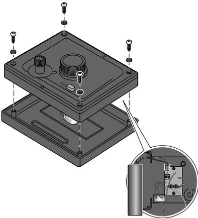
3. Lösen Sie die Schrauben auf der Unterseite des Solarmoduls mit einem Kreuzschlitzschraubendreher und nehmen Sie die Abdeckung ab.
