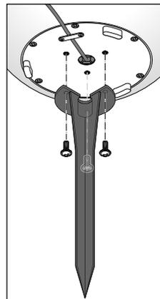
6. Befestigen Sie den anderen Erdspeer mit den beiliegenden Schrauben an der Unterseite der Solar-Outdoorleuchte.
