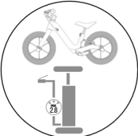
Däckens tryck ska vara 2,8 bar. Däcken är inte fullt pumpade under transporten. Det är nödvändigt att pumpa upp däck till max. 2,8 bar före första användningen.
