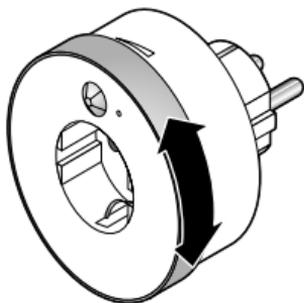
▷ Drehen Sie den Drehschalter im bzw. gegen den Uhrzeigersinn, um eine der 3 Helligkeitsstufen einzustellen.
