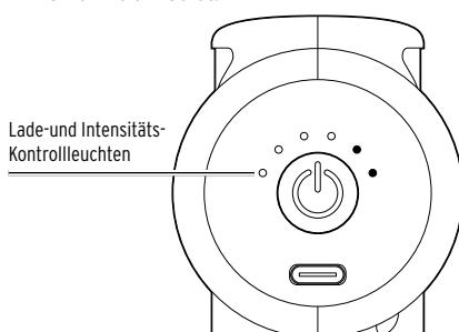
**i** Um sich den Ladestand des Akkus anzeigen zu lassen, drücken Sie die Taste kurz.
