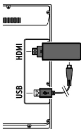
Alternativ können Sie den Konsolenstick auch direkt (ohne HDMI-Verlängerungskabel) an Ihr Fernsehgerät anschließen und das USB-C-Kabel in die entsprechende USB-Buchse an Ihrem Fernsehgerät (sofern vorhanden) stecken.
