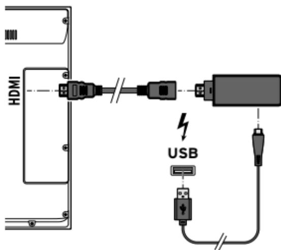
2. Schließen Sie das HDMI-Verlängerungskabel und das USB-C-Kabel wie abgebildet an den Konsolenstick an.
