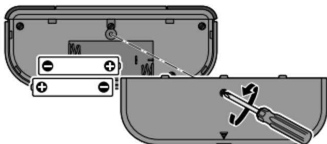
1. Lösen Sie die Schraube am Batteriefach und klappen Sie den Batteriefachdeckel dann an der mit dem Pfeil markierten Stelle auf.
