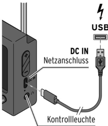
▷ Verbinden Sie mit dem beiliegenden Anschlusskabel die Netzanschluss-Buchse **DC IN** mit einem USB-Netzadapter und stecken Sie diesen in eine gut erreichbare Steckdose.
