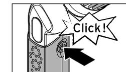
... drücken Sie bis zum Anschlag auf die Ein-/Aus-Taste, um die Reinigungsbürste auszuschalten. Die Kontroll-Leuchte erlischt. Schließen Sie die Reinigungsbürste wie oben beschrieben zum Laden an das Stromnetz an.
