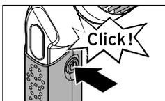
4. Zum Einschalten drücken Sie bis zum Anschlag auf die Ein-/Aus-Taste.
