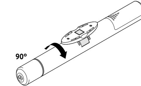
Die LED-Multifunktionsleuchte ist mit einem Bewegungssensor ausgestattet. Der Bewegungssensor ist bis zu 180° drehbar.
