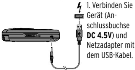
1. Verbinden Sie Gerät (Anschlussbuchse **DC 4.5V**) und Netzadapter mit dem USB-Kabel.
