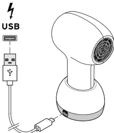
1. Schließen Sie das beiliegende USB-Ladekabel an den USB-C-Anschluss **DC5V** an der Ladestation und an einen geeigneten USB-Netzadapter (siehe „Technische Daten“) an. Stecken Sie den Netzadapter in eine Netzsteckdose.
