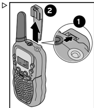
**Gürtelclip abnehmen:** Ziehen Sie die Lasche des Gürtelclips wie abgebildet in Pfeilrichtung und ziehen Sie den Gürtelclip dann nach oben aus der Führung heraus.
