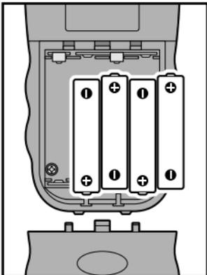
Legen Sie die Batterien ein, wie auf dem Boden des Batteriefachs abgebildet. Achten Sie dabei auf die richtige Polarität (+/-).
