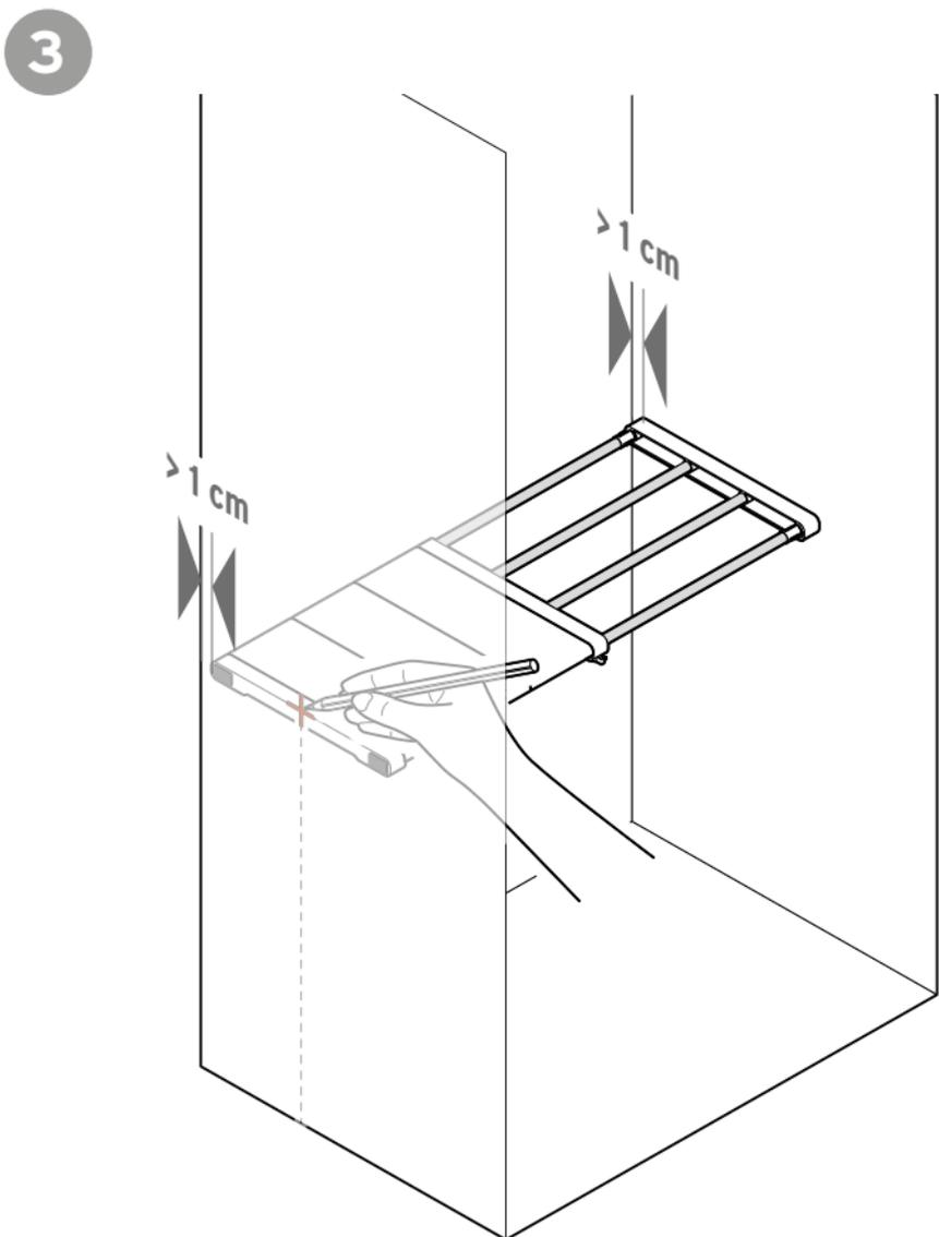
1. Schieben Sie den Regalboden an der gewünschten Stelle zwischen die beiden Seitenwände, an denen Sie ihn befestigen möchten. Halten Sie einen Mindestabstand von 1 cm nach hinten zur Rückwand ein, sonst lassen sich die Flügelschrauben später nicht mehr drehen.
