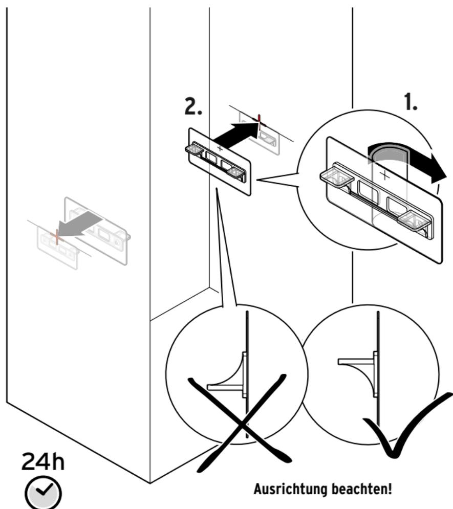
1. Ziehen Sie die Schutzfolien von den Klebehaltern ab.
