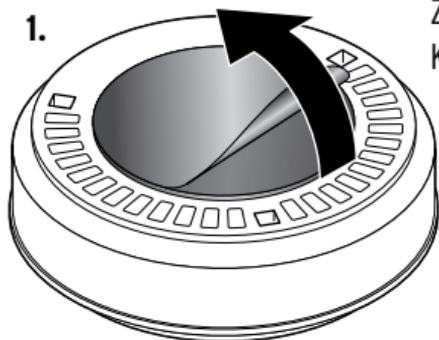
Ziehen Sie die Schutzfolie von der Klebefläche auf der Rückseite ab.
