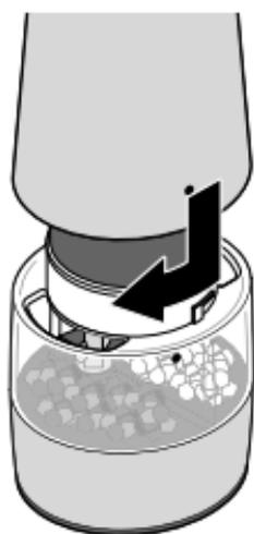
1. Setzen Sie das Gehäuse wieder auf den Mahlgutbehälter. Der Punkt auf dem Gehäuse liegt dabei vor dem Punkt am Mahlgutbehälter.
