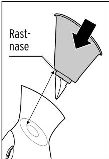
7. Stecken Sie den Dampfaufsatz wieder so in das Gerät, dass die Rastnase am Dampfaufsatz genau in die Aussparung am Dampfauslass greift. Drehen Sie den Dampfaufsatz ggf. etwas hin und her, bis er spürbar fest sitzt.
