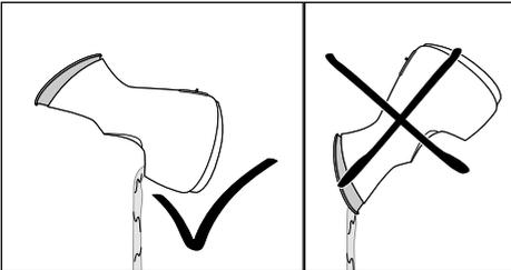
1. Entfernen Sie Restwasser aus dem Gerät, indem Sie das Gerät über einem Spülbecken leicht neigen, bis das Wasser **aus der Wassertank-Aufnahme** herausfließt. Versuchen Sie auf keinen Fall, Restwasser über den Dampfauslass auszugießen!
