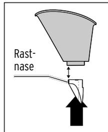
4. Stecken Sie den Kräuterbehälter wieder so in den Dampfaufsatz, dass die Rastnase am Kräuterbehälter genau in die Aussparung am Dampfaufsatz greift.
