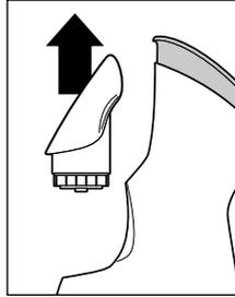
1. Ziehen Sie den Wassertank nach oben aus dem Gerät heraus.
