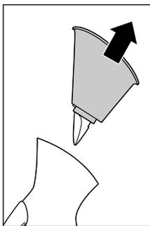
1. Bewegen Sie den Dampfaufsatz leicht nach rechts und links und ziehen ihn dann schräg nach oben vom Gerät ab.
