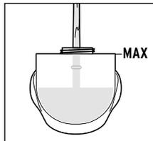
3. Füllen Sie destilliertes/entmineralisiertes Wasser (alternativ stilles Tafelwasser) mit Zimmertemperatur **bis zum Rand** in den Wassertank. Maximale Füllmenge: 60 ml.
