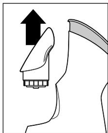
1. Ziehen Sie den Wassertank nach oben aus dem Gerät heraus.
