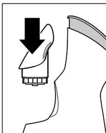
6. Setzen Sie den Wassertank wieder in das Gerät ein.
