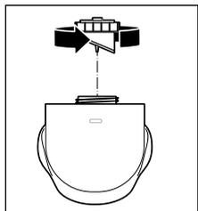
2. Drehen Sie den Deckel gegen den Uhrzeigersinn vom Wassertank ab.
