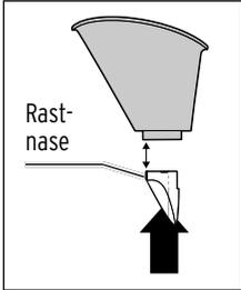
5. Stecken Sie den Kräuterbehälter wieder so in den Dampfaufsatz, dass die Rastnase am Kräuterbehälter genau in die Aussparung am Dampfaufsatz greift.
