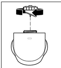
5. Drehen Sie den Deckel im Uhrzeigersinn wieder auf den Wassertank.
