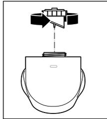
2. Drehen Sie den Deckel gegen den Uhrzeigersinn vom Wassertank ab.
