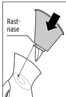
5. Stecken Sie den Dampfaufsatz wieder so in das Gerät, dass die Rastnase am Dampfaufsatz genau in die Aussparung am Dampfauslass greift. Drehen Sie den Dampfaufsatz ggf. etwas hin und her, bis er spürbar fest sitzt.
