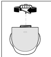
4. Drehen Sie den Deckel im Uhrzeigersinn wieder auf den Wassertank und trocknen Sie den Wassertank von außen gut ab.
