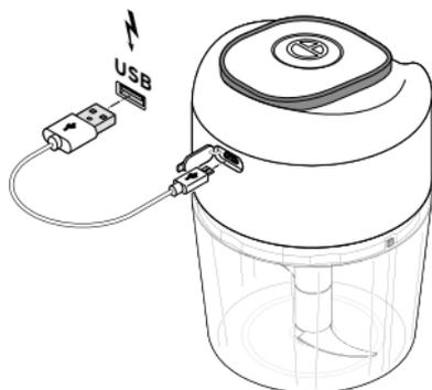
1. Öffnen Sie die Abdeckkappe der USB-Ladebuchse am Motorblock.
