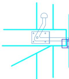
Schritt 5 : Schließteil so verschrauben
