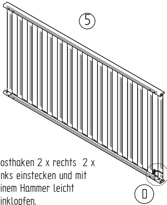
Rosthaken 2 x rechts 2 x links einstecken und mit einem Hammer leicht einklopfen.
