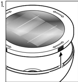
1. Drehen Sie jeweils die Leuchtenkopf-Abdeckung gegen den Uhrzeigersinn und heben Sie sie nach oben ab.
