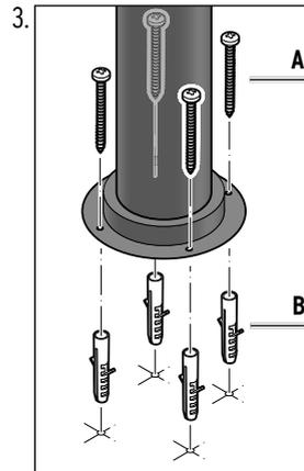
Bohren Sie die Löcher und befestigen Sie den Sockel mit den Schrauben **A** und den Dübeln **B** am Boden.
