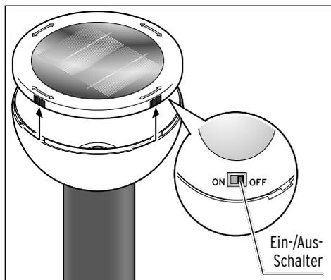
1. Drehen Sie jeweils die Leuchtenkopf-Abdeckung gegen den Uhrzeigersinn bis zum Anschlag und heben Sie sie nach oben ab.
