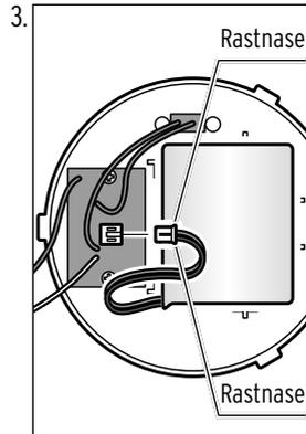
3. Drücken Sie die Rastnasen am Stecker des alten Akkupacks zusammen und ziehen Sie den Stecker ab. Nehmen Sie ggf. eine Flachzange zur Hilfe.
