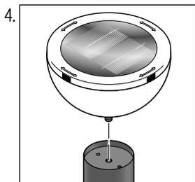
Drehen Sie den Leuchtenkopf handfest oben in das Gewinde der Standsäule.
