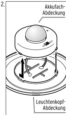
2. Drehen Sie jeweils die Akkufach-Abdeckung gegen den Uhrzeigersinn und heben Sie sie nach oben ab.
