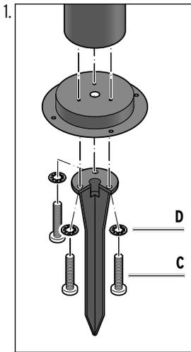
Schrauben Sie jeweils den Erdspieß und den Sockel von unten mit den Schrauben **C** und den Unterlegscheiben **D** an die Standsäule.
