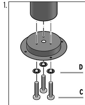
Schrauben Sie jeweils den Sockel der Standsäule mit den Schrauben **C** und den Unterlegscheiben **D** von unten an die Standsäule.
