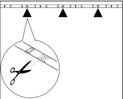
Kürzen Sie die Lichtleiste bei Bedarf mit einer scharfen Schere an einer der dafür vorgesehenen, kupferfarbenen Stellen (insgesamt acht). Schneiden Sie gerade entlang der aufgedruckten schwarzen Linie. **Schneiden Sie nicht die Seite mit dem Stecker ab!**
