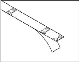
Ziehen Sie die Schutzfolie vom Selbstklebestreifen. Befestigen Sie die Lichtleiste sorgfältig auf dem ausgewählten Untergrund, indem Sie sie andrücken. Platzieren und befestigen Sie die Halterung entsprechend.
