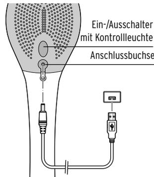
1. Öffnen Sie die Abdeckung der Anschlussbuchse am Gerät.
