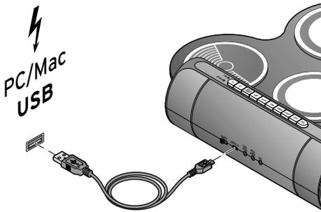
1. Verbinden Sie den Micro-USB-Stecker des USB-Kabels mit der Anschlussbuchse **USB/DC 5V** des Gerätes und den USB-A-Stecker mit dem beiliegenden USB-Netzadapter oder Ihrem Computer.
