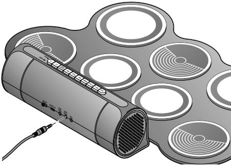
▷ Schließen Sie das externe Wiedergabegerät mit dem beiliegenden Audiokabel mit 3,5-mm-Klinkenstecker an die Anschlussbuchse **HEADPHONE** an.
