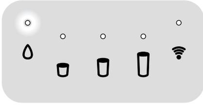
Wenn die Pflege-Taste dauerhaft **rot** leuchtet, muss die Maschine entkalkt werden.
