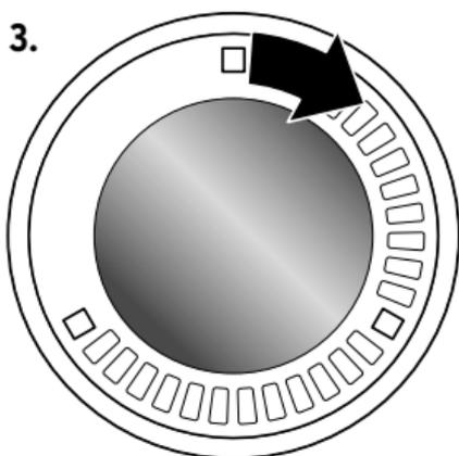
Setzen Sie die Batteriefachabdeckung wieder korrekt auf und drehen Sie sie im Uhrzeigersinn bis zum Anschlag fest.
