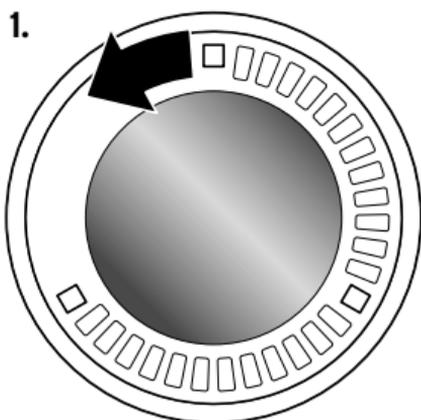
Drehen Sie die Batteriefachabdeckung auf der Rückseite gegen den Uhrzeigersinn. Heben Sie die Batteriefachabdeckung nach oben ab.
