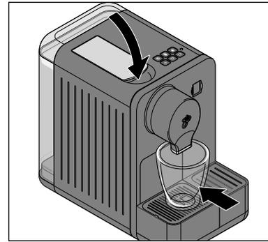
2. Klappen Sie den Hebel ganz herunter. Die eingesetzte Kapsel wird dabei in Boden und Deckel angestochen.
