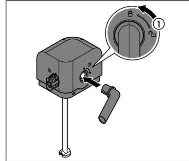
6. Stecken Sie den Milch-Auslauf ① wie abgebildet in den Milch-behälterdeckel und drehen Sie ihn gegen den Uhrzeigersinn bis zum Anschlag.
