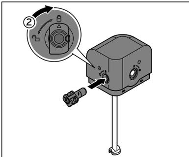
5. Stecken Sie den Anschluss-stutzen ② wie abgebildet in den Milchbehälterdeckel und drehen Sie ihn im Uhrzeigersinn bis zum Anschlag.
