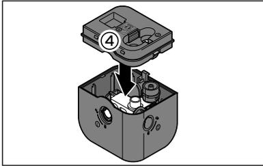
3. Setzen Sie die Abdeckung ④ auf den Milchbehälterdeckel. Die Abdeckung muss hörbar und spürbar einrasten.
