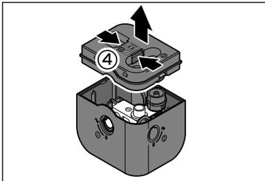
4. Halten Sie die beiden roten Tasten ④ fest gedrückt und ziehen Sie die Abdeckung nach oben ab.
