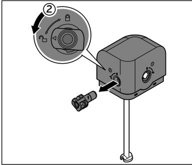
2. Drehen Sie den Anschlussstutzen ② gegen den Uhrzeigersinn bis zum Anschlag und ziehen Sie ihn vom Deckel ab.
