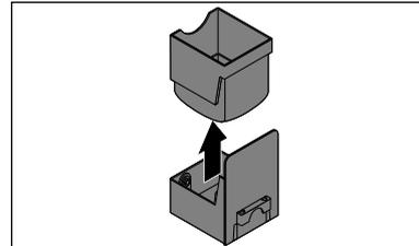
3. Entnehmen Sie den Kapsel-Auffangbehälter. Der Kapsel-Auffangbehälter muss täglich geleert werden bzw. wenn er voll ist. In den Auffangbehälter passen ca. 6 Kapseln hinein.
