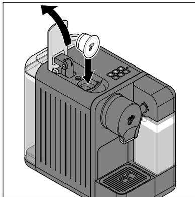
1. Klappen Sie den Hebel bis zum Anschlag zurück und setzen Sie eine Kapsel wie abgebildet mit dem Deckel zur Frontseite ein.
