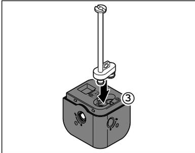
4. Stecken Sie den Ansaug-schlauch ③ bis zum Anschlag in die Öffnungen in der Abdeckung.
