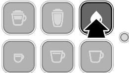
15. Drücken Sie kurz die Taste **Milchsystem spülen**, um die Leitungen bzw. Verbindungsschläuche zum Milchbehälter durchzuspülen.
