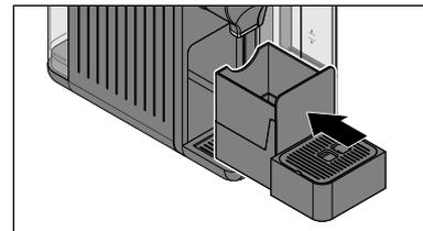
4. Vergewissern Sie sich, dass der Kapsel-Auffangbehälter korrekt in der Frontschublade sitzt. Die Frontschublade muss bis zum Anschlag eingeschoben und die Abtropfschale korrekt eingesetzt sein.
