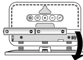
1. Greifen Sie in die Aussparung über dem Batteriefach und klappen Sie den Batteriefachdeckel hoch und nehmen Sie ihn ab.
