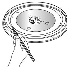
Halten Sie den Leuchtenhalter an die Stelle, an der Sie die Leuchte montieren wollen, und markieren Sie die Bohrlöcher.
