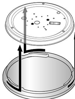
Drehen Sie den Leuchtenhalter gegen den Uhrzeigersinn bis zum Anschlag und nehmen ihn von der Leuchtenabdeckung ab.
