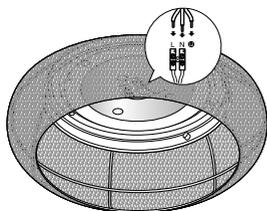
Lassen Sie die Stromleitungen von einer Fachkraft mit der Lüsterklemme verbinden.
