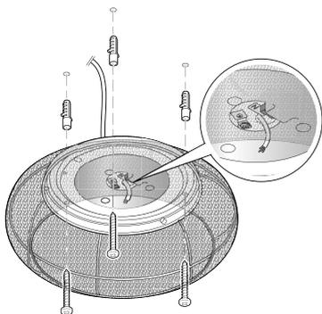
Führen Sie die Stromleitungen (Deckenkabel) durch die Kabelführung des Leuchtenhalters. Befestigen Sie den Leuchtenhalter samt aufgesetztem Lampenschirm mit den Schrauben und Dübeln an der Decke.
