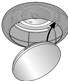
Stecken Sie die Leuchtenabdeckung schräg durch die Öffnung im Lampenschirm.
