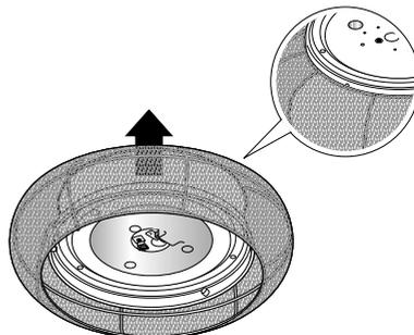
Setzen Sie den Leuchtenhalter wie abgebildet von unten passgenau in den Lampenschirm ein.
