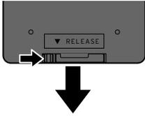
1. Drücken Sie die Arretierung in Pfeilrichtung und ziehen Sie die Batteriehalterung heraus.
