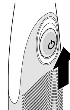
3. Um das Gerät **einzuschalten**, schieben Sie den Ein-/Ausschalter nach oben. Die Borsten oszillieren.
