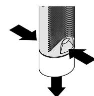
1. Drücken Sie auf beiden Seiten auf die Druckflächen und ziehen Sie den Batteriefachdeckel vom Gerät ab.
