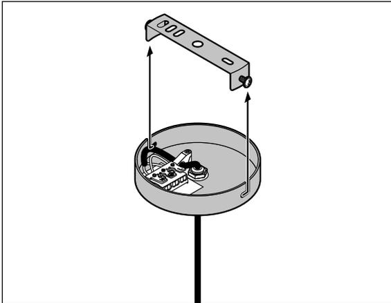
3. Lösen Sie die beiden seitlichen Befestigungsschrauben, mit denen der Deckenbügel am Leuchenträger befestigt ist, so weit, dass Sie den Deckenbügel abnehmen können.
