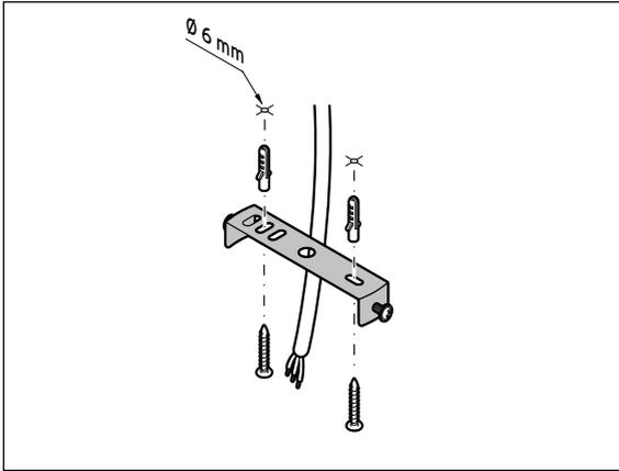
3. Befestigen Sie den Deckenbügel mit den Dübeln und Schrauben an der Decke.
