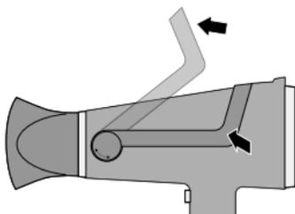
Greifen Sie den Ständer auf beiden Seiten an der Ecke und ziehen Sie ihn bis zum Anschlag hoch.
