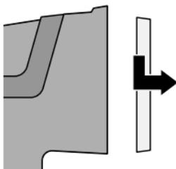
Drehen Sie das Luftgitter gegen den Uhrzeigersinn und nehmen Sie es ab.
