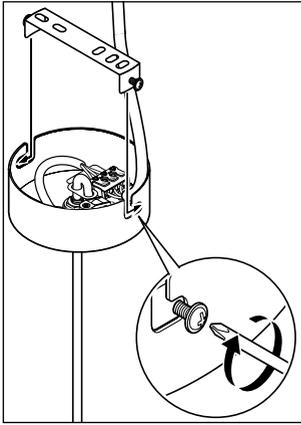
1. Schieben Sie den Leuchtenträger nach oben über die Anschlüsse und drehen Sie die Befestigungsschraube wieder fest.
