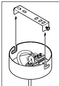
2. Lösen Sie die beiden seitlichen Befestigungsschrauben, mit denen der Deckenbügel am Leuchenträger befestigt ist, so weit, dass Sie den Deckenbügel abnehmen können.
