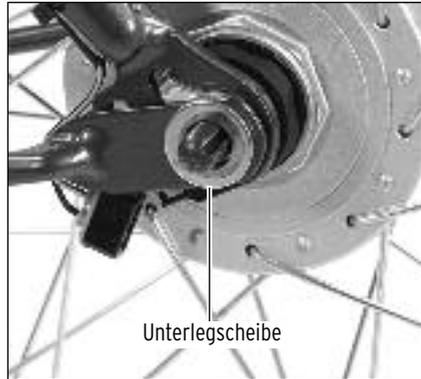
3. Lösen Sie die Hutmutter an der Radachse und nehmen Sie die Unterlegscheiben ab.
