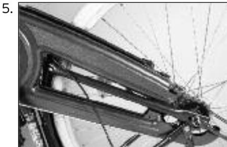
Heben Sie den oberen Teil der vorderen Verkleidung vor die Hinterradstrebe und drehen Sie die ganze vordere Verkleidung etwas im Uhrzeigersinn.
