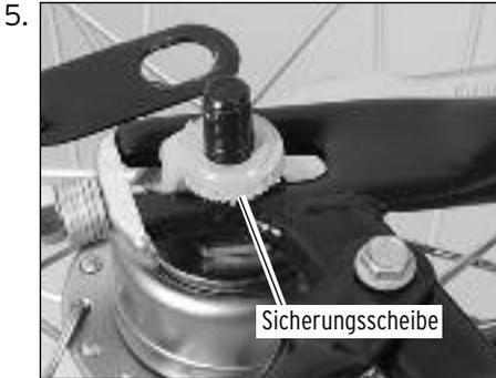
Schieben Sie die gelbe Sicherungsscheibe in Fahrtrichtung links auf die Radachse. Die Nase muss dabei in die Aussparung am Rahmen greifen.
