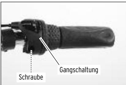
Lösen Sie die Schraube an der Gangschaltung um ca. 2 Umdrehungen.
