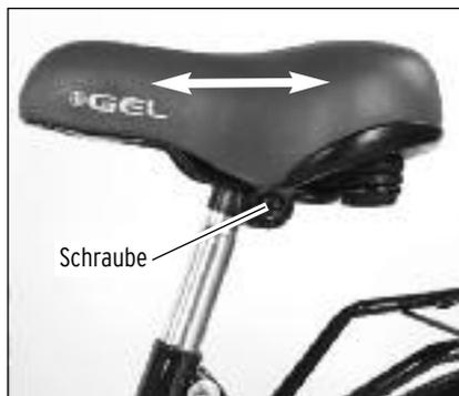
4. Um den Sattel in Längsrichtung zu verstellen, lösen Sie die Schraube unter dem Sattel.
