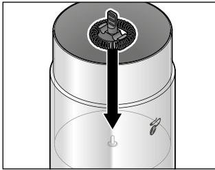
2. Stecken Sie den Rührersatz wie abgebildet (mit dem Griff nach oben) auf den Stützen im Inneren des Milchaufschäumers.
