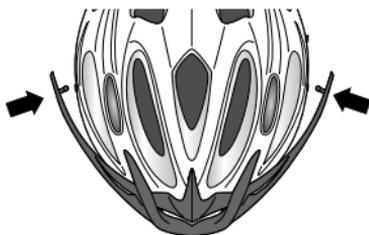
... und drücken anschließend die seitlichen an, bis sie hör- und spürbar einrasten.
