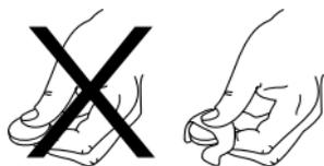
Durch Berührung der Batterie mit bloßen Händen können an den Kontakten Verunreinigungen entstehen, die unter Umständen isolierend wirken. Verwenden Sie daher beim Einsetzen ein trockenes, weiches Tuch.
