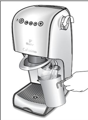
Drehen Sie den Drehknopf langsam gegen den Uhrzeigersinn über den Widerstand hinaus. Machen Sie kreisende Bewegungen mit dem Behälter. Dabei sollte die Aufschäumdüse immer unter der Oberfläche der Milch bleiben. Hat sich ausreichend Schaum gebildet, drehen Sie den Drehknopf im Uhrzeigersinn zu. Der Schaum ist nun für die weitere Verwendung fertig.
