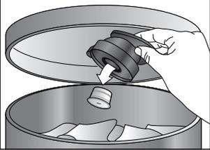
Drehen Sie den Kapselhalter über einem Mülleimer auf den Kopf. Die benutzte Kapsel fällt heraus.
