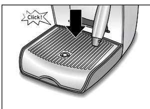
Schieben Sie die Abtropfschale bis zum Anschlag in das Gerät und drücken Sie sie dann nach unten. Sie muss hörbar und spürbar einrasten.
