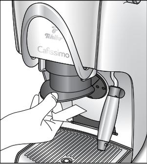
Drücken Sie den Arretierhebel nach oben. Der Kapselhalter wird entriegelt und leicht abgesenkt. Ziehen Sie nun den Kapselhalter nach vorne aus der Maschine. Halten Sie ggf. einen Teller darunter, um eventuelle Tropfen aufzufangen.
