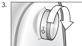
3. Prüfen Sie, ob das Dampfventil geschlossen ist: Drehen Sie den Drehknopf bis zum Anschlag im Uhrzeigersinn.
