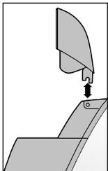
Zum Abnehmen und Aufsetzen muss der Deckel senkrecht nach oben stehen wie abgebildet. Nur so lässt sich der Deckel abnehmen oder aufsetzen.
