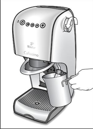
Halten Sie ein hitzebeständiges Gefäß unter die Aufschäumdüse.
