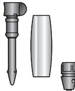
Zerlegen Sie die Aufschäumdüse in 3 Teile und spülen Sie die Teile gründlich ab.
