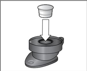
Setzen Sie eine Kapsel in den Kapselhalter ein. Die Kapsel muss unversehrt sein: **Nicht** anstechen und **nicht** den Deckel entfernen!
