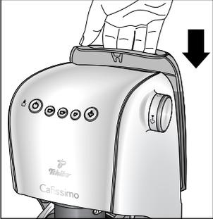
Setzen Sie den Wasserbehälter wieder ein. Drücken Sie ihn dabei ggf. ein wenig herunter, so dass sich das Ventil im Boden des Wasserbehälters mit dem Gehäuse verbindet.
