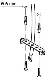
3. Befestigen Sie den Deckenbügel mit den Dübeln und Schrauben an der Decke.
