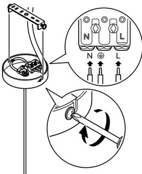
1. Lassen Sie die Stromleitung von einer Fachkraft mit der Lüsterklemme verbinden.
