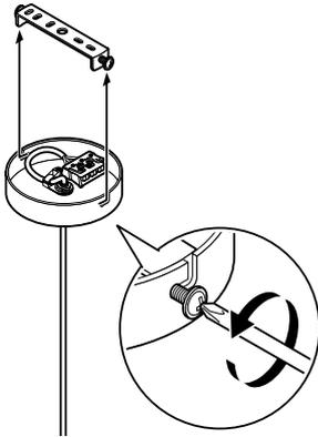
3. Lösen Sie die beiden seitlichen Befestigungsschrauben, mit denen der Deckenbügel am Baldachin befestigt ist, so weit, dass Sie den Deckenbügel abnehmen können.
