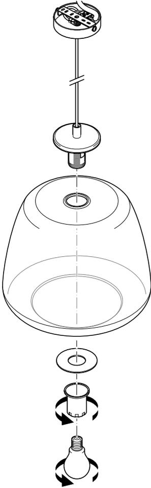
1. Drehen Sie Abdeckzylinder ab und nehmen Sie Abdeckzylinder und Haltering von der Fassung.
