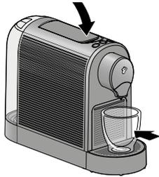
4. Klappen Sie ggf. den Hebel herunter, **ohne eine Kapsel einzusetzen**.
