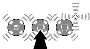
7. Klappen Sie den Hebel herunter **ohne eine Kapsel einzusetzen**.
