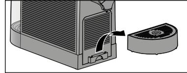
10. Leeren Sie zum Schluss die Frontschublade und ggf. den Kapsel-Auffangbehälter:
