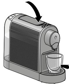
2. Klappen Sie den Hebel ganz herunter. Die eingesetzte Kapsel wird dabei in Boden und Deckel angestochen.
