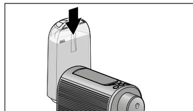
6. Setzen Sie den Wassertank wieder in die Maschine ein. Drücken Sie ihn bis zum Anschlag herunter.
