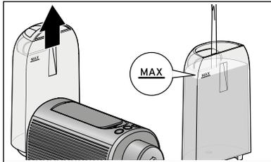
1. Ziehen Sie den Wassertank gerade nach oben aus der Maschine heraus.
