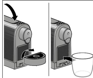
6. Klappen Sie den Hebel herunter und entfernen Sie die Abtropfschale.
