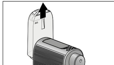
3. Ziehen Sie den Wassertank gerade nach oben aus der Maschine heraus.
