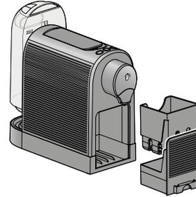
11. Nehmen Sie den Wassertank, die Frontschublade und den Kapsel-Auffangbehälter aus der Maschine.
