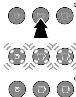
▷ Drücken Sie kurz eine beliebige Taste, um die Maschine einzuschalten. Ein kurzer Signalton ertönt.
