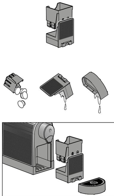
3. Entnehmen Sie den Kapsel-Auffangbehälter. Der Kapsel-Auffangbehälter muss täglich geleert werden bzw. wenn er voll ist. In den Auffangbehälter passen ca. 6 Kapseln hinein.
