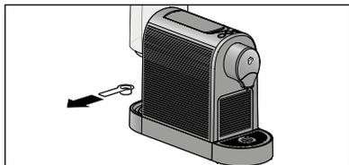
3. Entfernen Sie den Transportschutz unter dem Wassertank.
