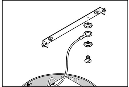
3. Halten Sie den Deckenhalter an die Stelle, an der Sie die Badleuchte montieren wollen, und markieren Sie die Bohrlöcher.
