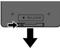
1. Drücken Sie die Arretierung in Pfeilrichtung und ziehen Sie die Batteriehalterung heraus.
