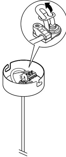
1. Schieben Sie das Anschlusskabel in den Leuchtenträger hinein.
