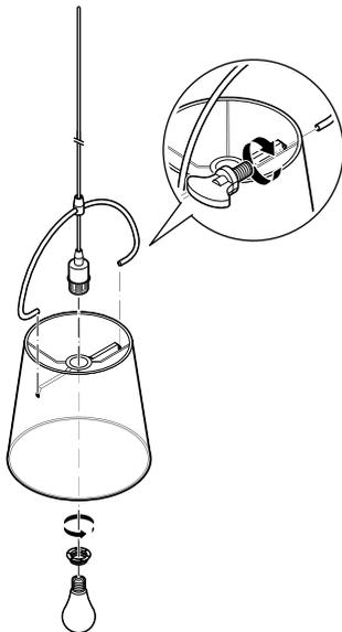
1. Befestigen Sie den Lampenschirm mit dem Fassungsring an der Fassung und mit den beiden Flügelschrauben am Bügel.
