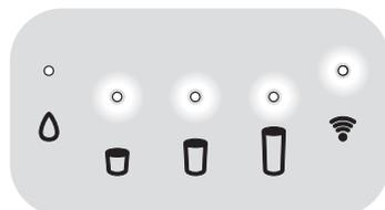
2 ▶ Warte einen kurzen Moment, bis die WLAN-Kontroll-Leuchte dauerhaft leuchtet.
