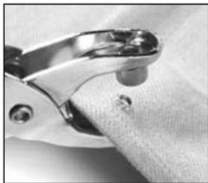
3. Setzen Sie die Nietenzange so an, dass die breite Seite der Niete auf dem Gegenstück der Nietauflage liegt.
