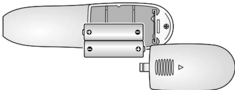
1. Öffnen Sie das Batteriefach auf der Geräterückseite, indem Sie leicht auf die geriffelte Fläche drücken und den Deckel in Pfeilrichtung abschieben.
