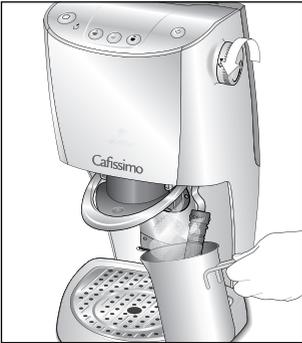
Drehen Sie den Drehknopf langsam gegen den Uhrzeigersinn und machen Sie kreisende Bewegungen mit dem Behälter. Dabei sollte die Aufschäumdüse immer unter der Oberfläche der Milch bleiben.
