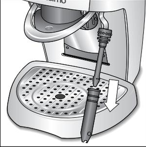
Ziehen Sie die Außenhülse der Aufschäumdüse nach unten ab.
