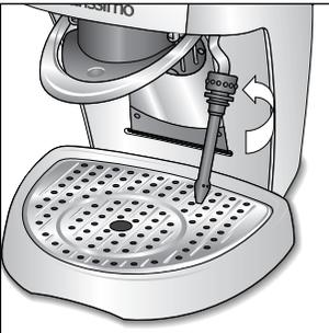
Drehen Sie die Rändelschraube der inneren Hülse los und ziehen Sie diese nach unten ab.
